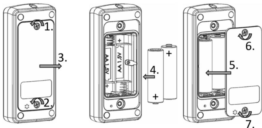
Veiller à ce que le joint du couvercle des piles soit intact et exempt de débris avant de remettre le couvercle en place. Montrer à l'utilisateur comment se servir du produit en toute sécurité.
